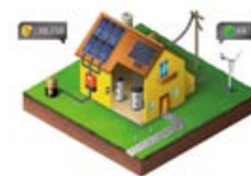
Smart home dotata di diversi device di produzione energetica e storage (impianto fotovoltaico, impianto termico per la produzione di acqua calda, pompa di calore, batteria)
